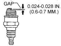
Figure 29. Spark Plug Gap
